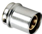
Il sistema di pressatura per i raccordi da 16 a 32 avviene mediante l'utilizzo di una pinza modello **TH** che deforma la bussola in acciaio inox AISI 304 solubilizzato determinando l'aggancio del tubo al raccordo.
