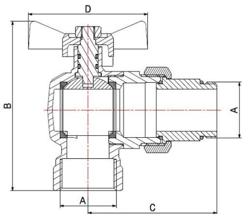
La valvola è adatta alla distribuzione e all'intercettazione di liquidi generalmente non corrosivi e compatibili con i materiali della valvola. Ottimo campo di applicazione è l'impiantistica dei settori idrotermosanitario, industriale e agricolo.
