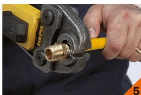
**Prima della pressatura controllare il buon funzionamento della pressatrice in dotazione art. 3810.** Posizionare la pinza TH art. 3811 in maniera **corretta**. L'anello rigonfio della bussola deve essere inserito nella scanalatura della pinza.
