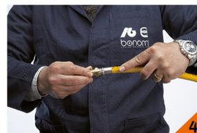
Inserire il tubo nel raccordo fino alla battuta con la rondella dielettrica, **assicurarsi** che il tubo sia nella posizione corretta grazie ai fori della bussola. **Evitare assolutamente l'utilizzo di raccordi visibilmente danneggiati.**
