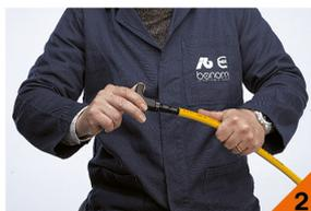
Calibrare con cura l'estremità del tubo usando l'apposito calibratore-svasatore art. 3813.
