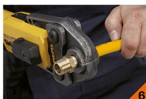
Eeguire la pressatura fino al contatto delle due ganasce della pinza. **Ricordarsi di controllare periodicamente lo stato d'usura, l'integrità e la pulizia delle ganasce di pressatura.**
