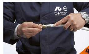
Inserire il tubo nel raccordo fino alla battuta con la rondella dielettrica, **assicurarsi** che il tubo sia nella posizione corretta grazie ai fori della bussola. **Evitare assolutamente l'utilizzo di raccordi visibilmente danneggiati.**
