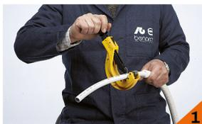
Tagliare perpendicolarmente il tubo con la cesoia art. 3812 evitando di deformarlo.
