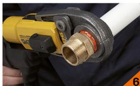
Eseguire la pressatura fino al contatto delle due ganasce della pinza.
