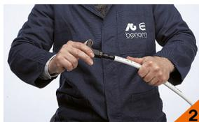
Calibrare con cura l'estremità del tubo usando l'apposito calibratore-svasatore art. 3813.
