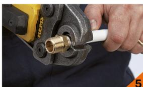
Prima della pressatura **controllare il buon funzionamento della pressatrice in dotazione art. 3810.**
