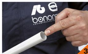
Verificare la corretta svasatura ed **eliminare** i residui di materiale che potrebbero **danneggiare** gli O-rings di tenuta.
